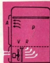
L'air froid, aspiré par le ventilateur (V) (tournant à 1.500 tours minutes) est projeté sur la résistance blindée (R) qui le renvoie chaud dans la penderie (P) d'où il se dégage par les trous d'aération (A).
